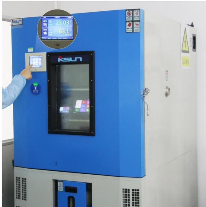
图 5-3 高低温老化测试图
