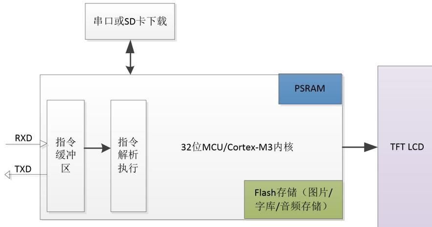
图 10-1 S 系列串口屏内部结构图
