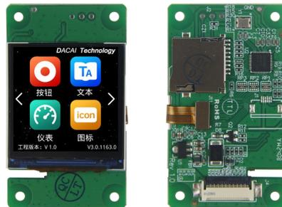
图 1-2 1.5 寸无触摸参考图
